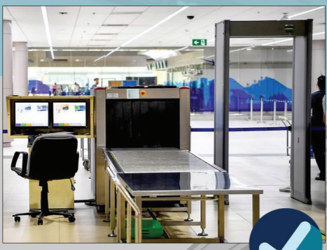
أجهزة فحص الحقائب Parcel and baggage inspection أجهزة كشف المعادن Walkthrough metal detector
